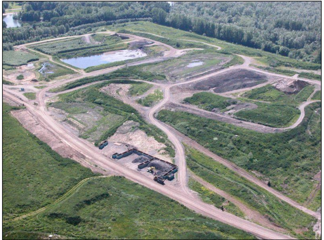
Foto: in het midden de twee vakken (met de grijze wanden) voor buffering van AVI-slakken (uit: PZH 06 053)
